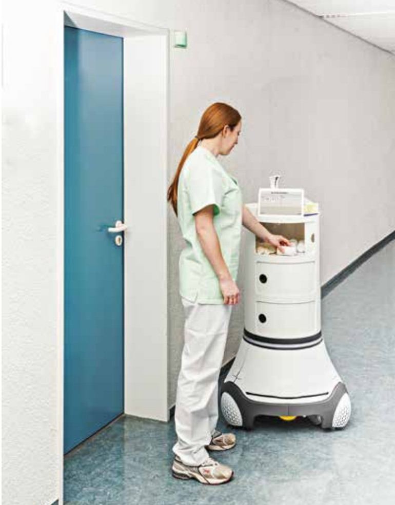
Der Care-O-bot unterstützt das Pflegepersonal. Er kann unter anderem Getränke servieren und Medikamente bringen.
